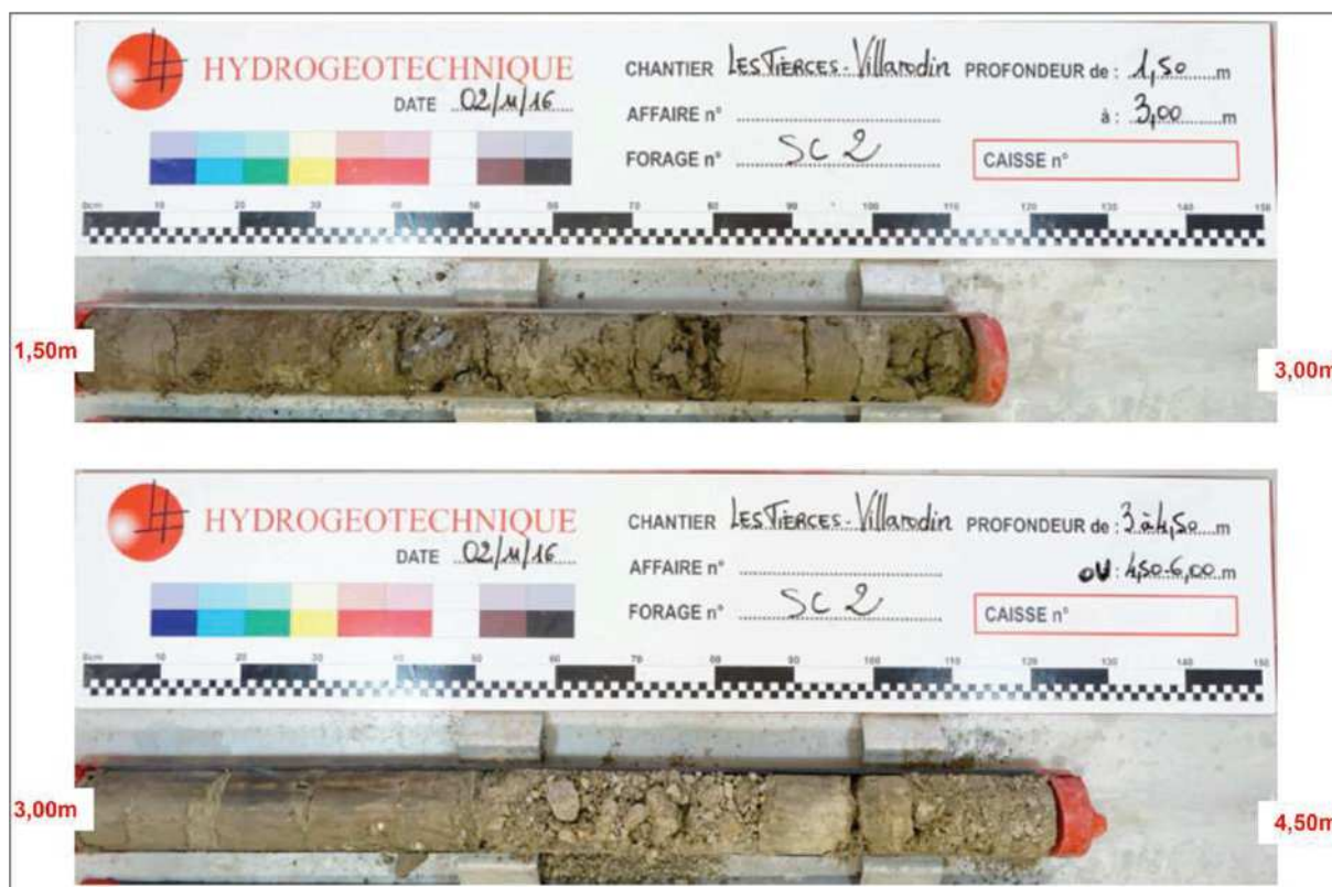
Figure 15 : Extrait des carottes du sondage SC2 (HYDROGÉOTECHNIQUE, janvier 2017)
